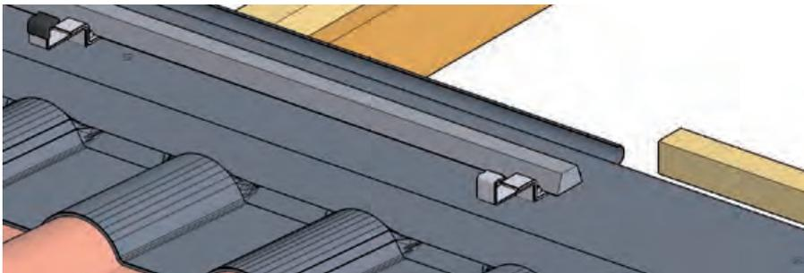
Abb. 16: Kehldichtstreifen verlegen
